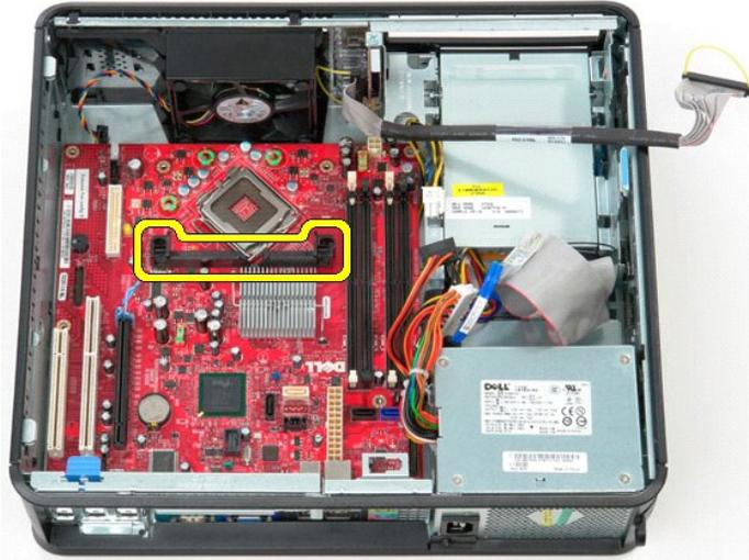
14. Untuk melepaskan board sistem, geser board sistem ke arah bagian belakang komputer dan angkat board sistem ke atas dan lepaskan dari komputer.
