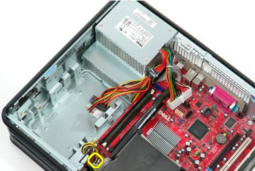
7. Lepaskan kabel konektor daya prosesor dari pengarah peruteannya di bawah board sistem.
